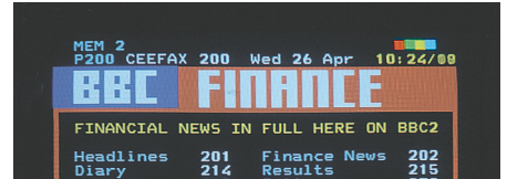
Een teletekstpagina met rechtsboven de gekleurde balk die aangeeft dat dit een Fastext-pagina is.
